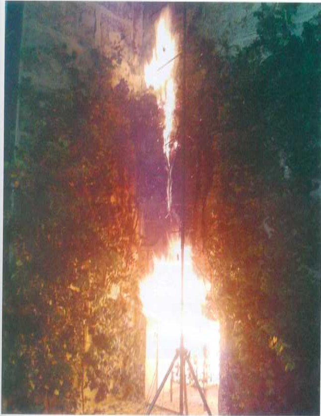
Eine begrünte Fassade mit Hedera helix im Brandversuch und danach
